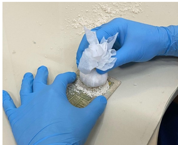
Figura 6: Processo de limpeza de cédula utilizando o pó de borracha e boneca de TNT
